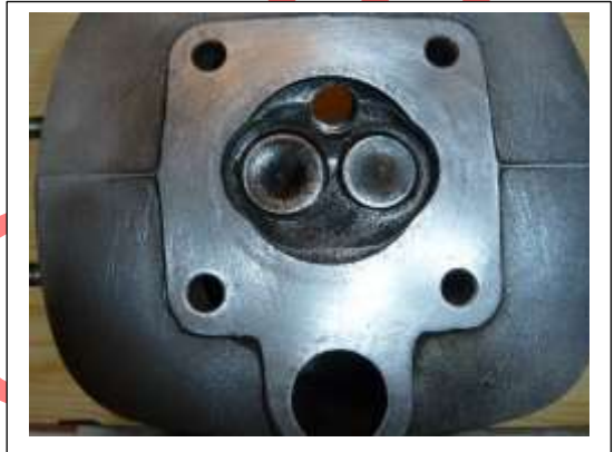
Sertissage le plus large coté cylindre Sertissage le moins large coté culasse
