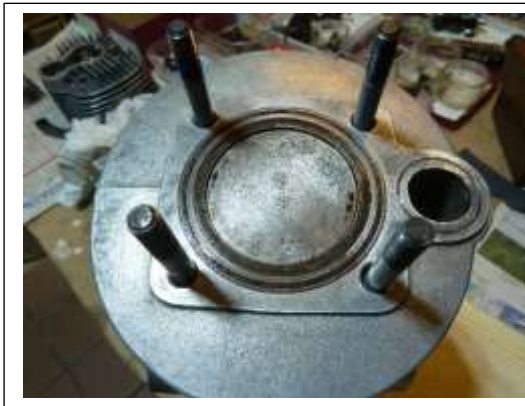
Sertissage le plus large coté cylindre Sertissage le moins large coté culasse
