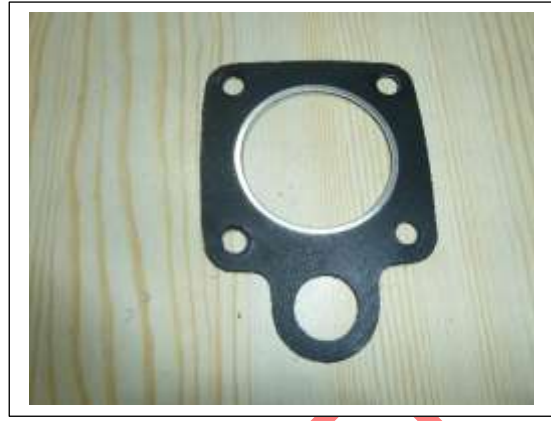
Sertissage le plus large coté cylindre Sertissage le moins large coté culasse
