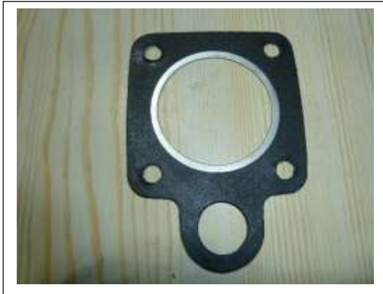
Sertissage le plus large coté cylindre Sertissage le moins large coté culasse
